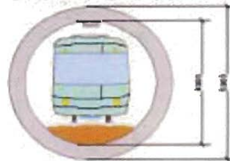
図7 地下鉄大江戸線トンネル断面図
